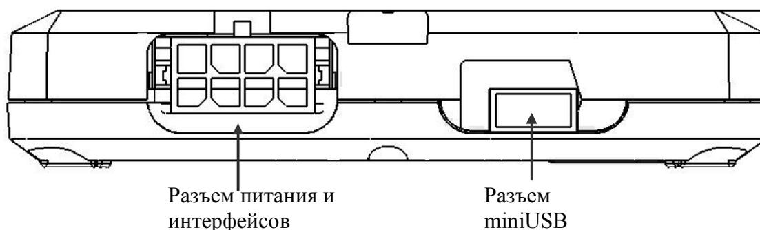
Рисунок 9. Вид «Гранит-навигатора.06» с боковой стороны (интерфейсные разъемы)
