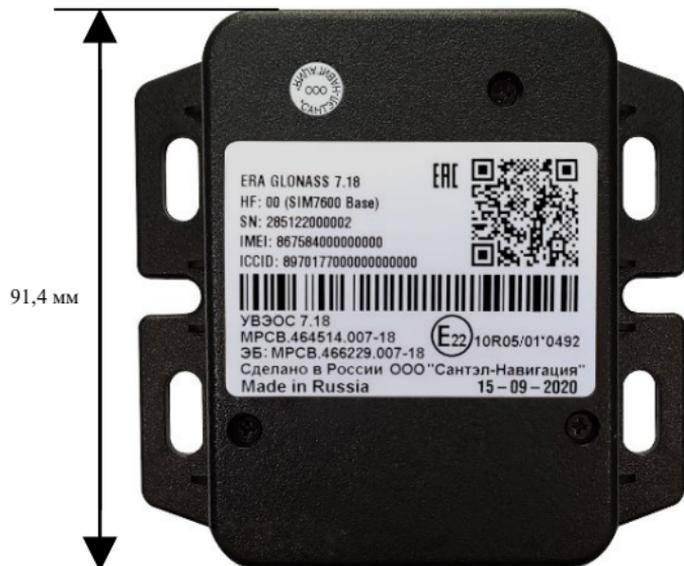
Рисунок 1 - Внешний вид электронного блока сверху
